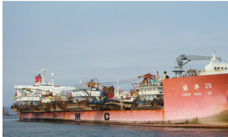
5. 선박 De-ballasting 작업
